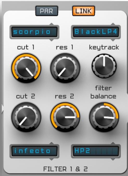
Spire verfügt über 2 Filter, denen unabhängig voneinander verschiedene Filtertypen zugewiesen werden können. Diese Filtertypen verfügen über verschiedene Filtermodi. Die Filter können parallel oder in Serie betrieben werden.
