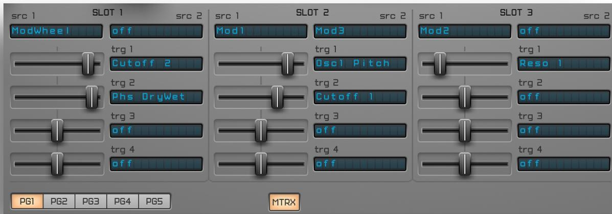
Spire's Modulationsmatrix bietet 15 Slots, mit jeweils 2 Modulationsquellen, und 4 Modulationszielen. Mögliche Modulationsquellen beinhalten die Oszillatoren, LFO's, Hüllkurven, Stepper, MIDI-Befehle und -Controller. So gut wie jeder von Spire's Parametern kann moduliert werden! Dies eröffnet nahezu grenzenlose Routing-Möglichkeiten!
