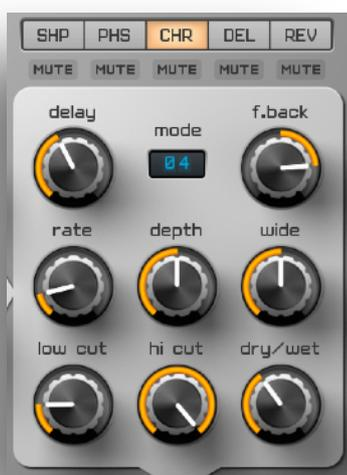
**Mode** – Modus Nummer **01** ist der Flanger-Modus. Die Modi **02-06** aktivieren unterschiedliche Chorus-Algorithmen. **J8** – Dieser Chorus-Algorithmus ist dem Klang des Chorus-Effekts des JP-8000 Hardware-Synthesizers nachempfunden.
