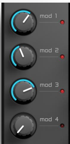
Die Makro-Controller Sektion besteht aus 4 Drehregler, die sowohl moduliert werden, als auch eine Modulationsquelle darstellen können. Die Zuweisung erfolgt dabei über die Modulationsmatrix, in der die Makro-Controller sowohl als Modulationsquelle, als auch als Modulationsziel ausgewählt werden können. Natürlich ist dabei auch eine Mehrfachzuweisung möglich, wenn man zum Beispiel die Verstimmung aller Oszillatoren gleichzeitig über einen Makro-Drehregler vornehmen möchte.
