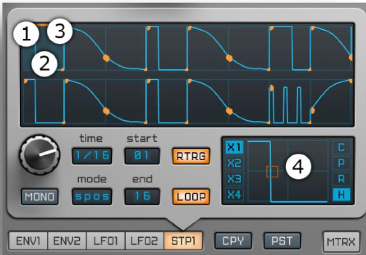
Der „Stepper“ ist ein vielseitiger Step-Sequencer mit einem flexiblen Wellenform-Editor. Sie können jedem Schritt (Step) eine gesonderte Wellenform zuweisen. Die einzelnen Wellenformen formen zusammen Sequenzen, die von einfachen bis zu sehr komplexen Pattern reichen.
