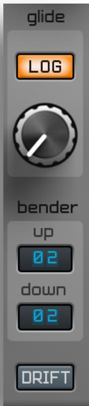
**DRIFT** – Schaltet die Drift-Funktion ein oder aus. Wenn Drift eingeschaltet ist, schwankt die Tonhöhe in einem Bereich von +/- 3 Cent in einem zufälligen Muster, das dem instabilen Tonhöhen-Drift von klassischen Analogsynthesizern nachempfunden wurde. Auch die Frequenz der LFO's driftet, wenn diese Option aktiviert ist.
