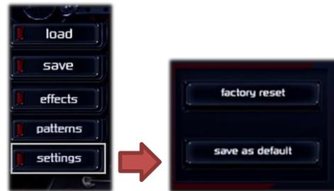
Mit Klick auf *save as default*, werden Ihre aktuellen Parameter und Werte als Standard-Preset gesichert, das automatisch eingeladen wird, wenn Sie eine Instanz von *Heavier7Strings* erzeugen.
