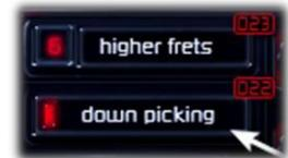
Standardmäßig ist der down-picking-Schalter MIDI-Controller CC #22 zugewiesen, Sie können jedoch jeden anderen MIDI CC nehmen, der nicht bereits zu einem anderen Parameter gemappt ist. Im nächsten Abschnitt erfahren Sie, wie MIDI CC #40 zur manuellen Steuerung des Picking verwendet wird.
