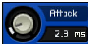
Damit bestimmen Sie, wie schnell der Filter nach An-schlagen der Tastatur geöffnet werden soll.
