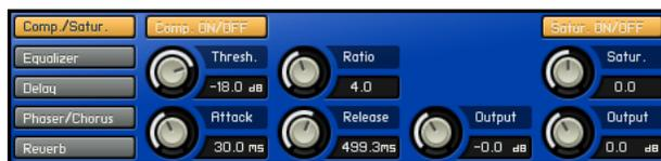
Der Compressor dient zum Komprimieren von Audiosignalen und kann zum Beispiel zum Hervorheben eines Instruments benutzt werden.
