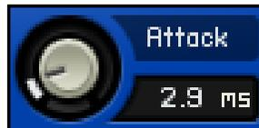
Damit bestimmen Sie wie schnell das Instrument nach Anschlagen der Tastatur seine maximale Lautstärke erreicht.
