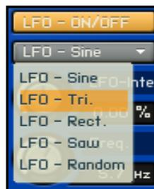
Schaltet den Low-Frequenz-Oszillator ein. Dient hier im Filterbereich zum Modulieren der Filterfrequenz.
