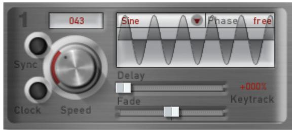
Neben den klangerzeugenden Oszillatoren gibt es im Largo zu Modulationszwecken drei Niederfrequenz-Oszillatoren, kurz LFO (Low Frequency Oscillator) genannt. Jeder LFO erzeugt eine periodische Wellenform mit einstellbarer Frequenz und Wellenform. LFO3 bietet zusätzlich die Möglichkeit eines frei definierbaren Step-LFO.
