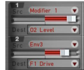
Der Largo bietet 16 unabhängige Modulationszuordnungen (slots) mit jeweils individuell einstellbaren Parametern für Modulationsquelle, Modulationsstärke und Modulationsziel. Die Modulations-Matrix ist eine der leistungsfähigsten Bestandteile eines jeden Waldorf Synthesizers. Sie sollten sie also auf jeden Fall ausnutzen!
