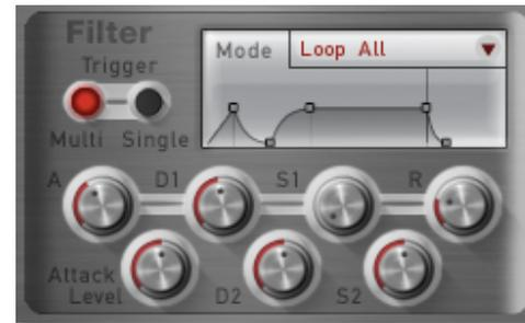
Die Hüllkurven des Largo ermöglichen die Beeinflussung von Klangparametern anhand zeitlicher Verläufe. Der Largo bietet vier unabhängig programmierbare Hüllkurven für jedes Sound-Programm:
