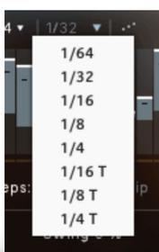
In den Arpeggiator-Modulen ist es möglich, gerade Werte und drei verschiedene Arten von Triolen als Arpeggiator-Rate auszuwählen. Wenn eine Triolen-Rate gewählt wird, passt der Rhythmus-Stepper die Anzahl der Schritte entsprechend an. Auf diese Weise deckt der Rhythmus-Stepper immer die Anzahl von Steps ab, die innerhalb der gewählten Taktart sinnvoll ist.
