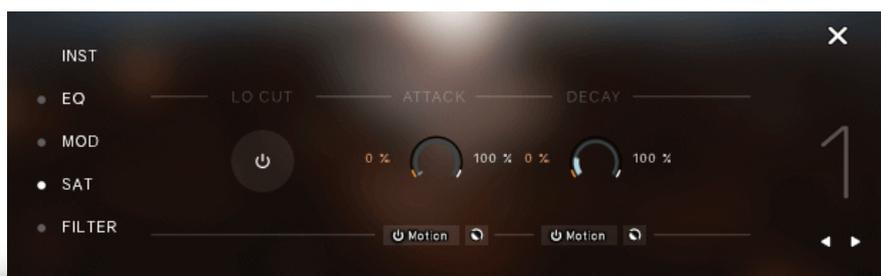
**Lo Cut:** Diese Taste schaltet einen festen Low Cut bei 80Hz ein / aus.
