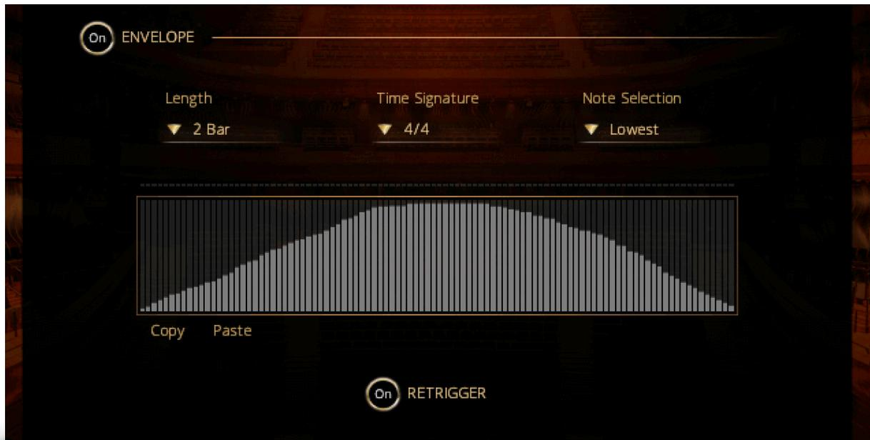
Mit Envelope können Sie eine wiederkehrende dynamische Form für anhaltende Noten festlegen. Das Herzstück ist die Hüllkurvenform, die durch Linksklick und Ziehen der Maus frei gezeichnet werden kann. Durch Rechtsklick und Ziehen mit der Maus können Sie eine gerade Linie zeichnen. Eine Reihe von zusätzlichen Bedienelementen ermöglicht es Ihnen, die Hüllkurve an Ihre Bedürfnisse anzupassen:
